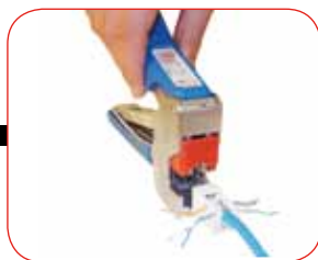
Paso N° 2: Colocar el conector MACH2 en la Herramienta MACH2e .
