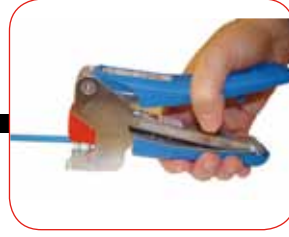
Paso N° 3: Presionar la herramienta MACH2e .
