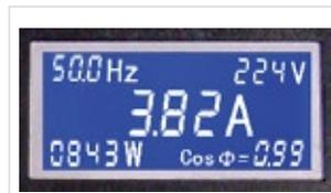
El Amperímetro Digital permite ver en todo momento el estado de la carga de la línea eléctrica.
